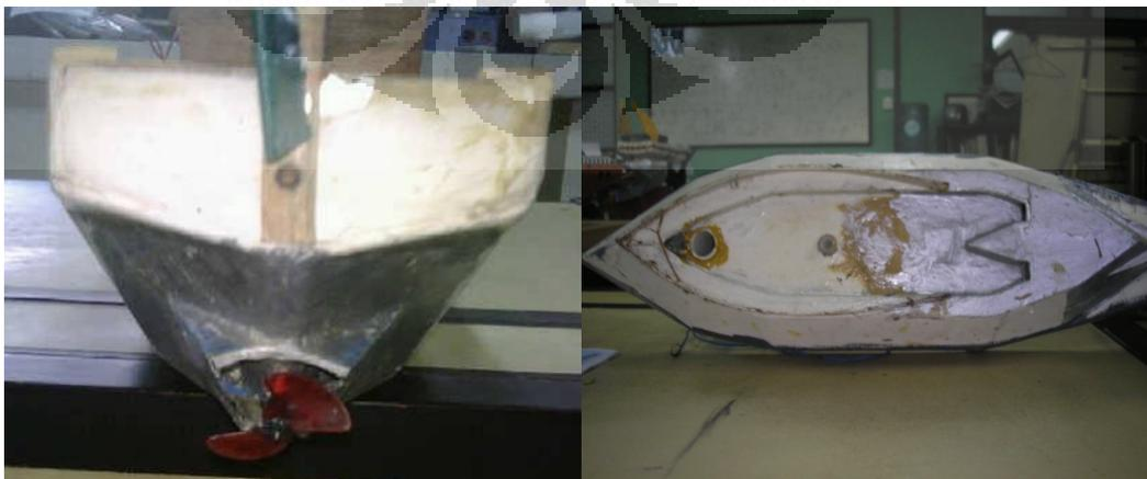
Gambar 3.10 Kapal model dengan pengarah penuh
