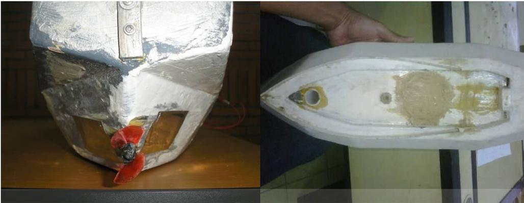
Gambar 3.8 Kapal model dengan *water tunnel* yang ditutup
