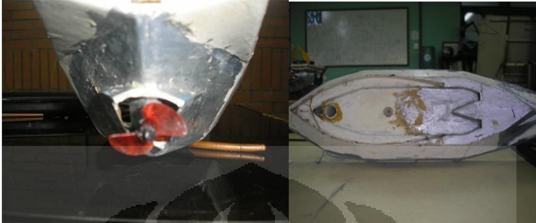
Gambar 3.11 Kapal model dengan pengarah setengah
