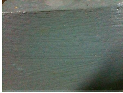
Gambar 4.6 Kondisi permukaan kapal dengan cat tanpa campuran kanji
