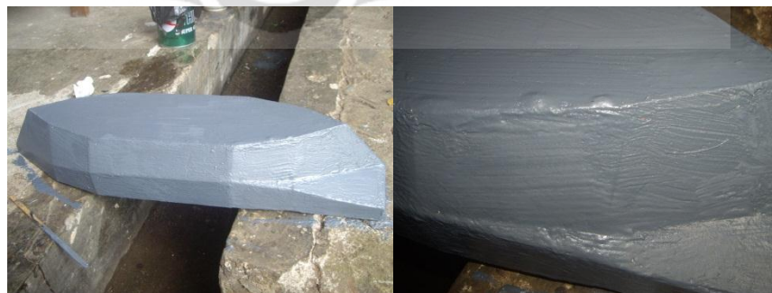
Gambar 4.5 Kondisi permukaan kapal dengan cat campuran 60% kanji pada tahap pertama
