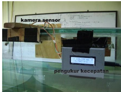
Gambar 3.17 Pemasangan sensor alat pengukur kecepatan
