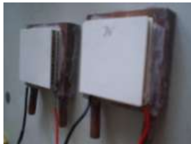
Gambar 3.9 Pasangan water block dengan modul termoelektrik dua tingkat
