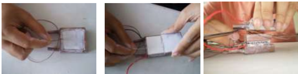
Gambar 4.4 Pemasangan Termokopel pada titik pengukuran (modul termoelektrik)
