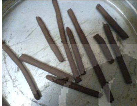
Gambar : Pengujian Indeks Propertis Tanah Kaolin
