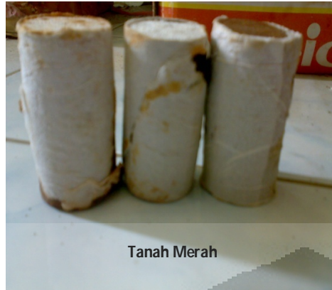
Gambar : Pola Keruntuhan Contoh Uji Hasil Uji Triaksial CU
