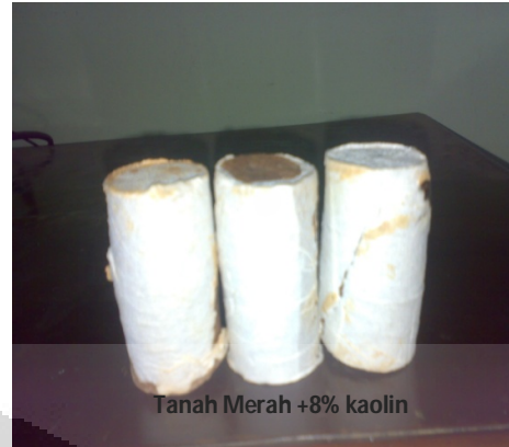
Gambar : Pola Keruntuhan Contoh Uji Hasil Uji Triaksial CU
