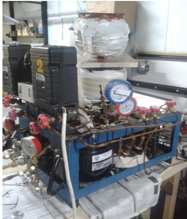
Gambar 3.1 Mesin Pengering Beku Vakum *Compact*
