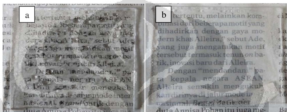
Gambar 4.9 Hasil Uji Anti Kabut Kondisi Film Setelah disiram air
