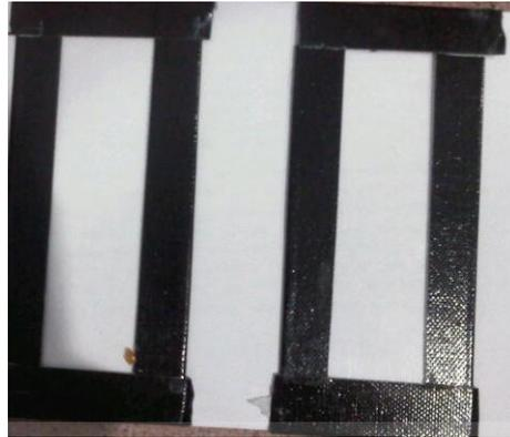
**Gambar 4. 11 Cetakan Komposit Serat BC dengan Resin**
