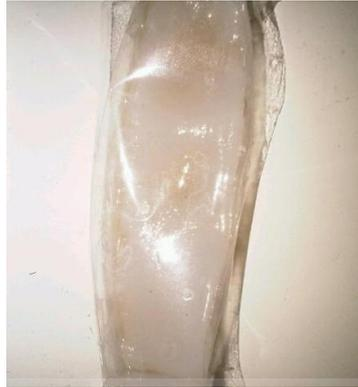
**Gambar 4.3 Serat *nata de coco* basah dengan lama perendaman 1 hari dalam suspensi nanosilika 3%(w/v)**
