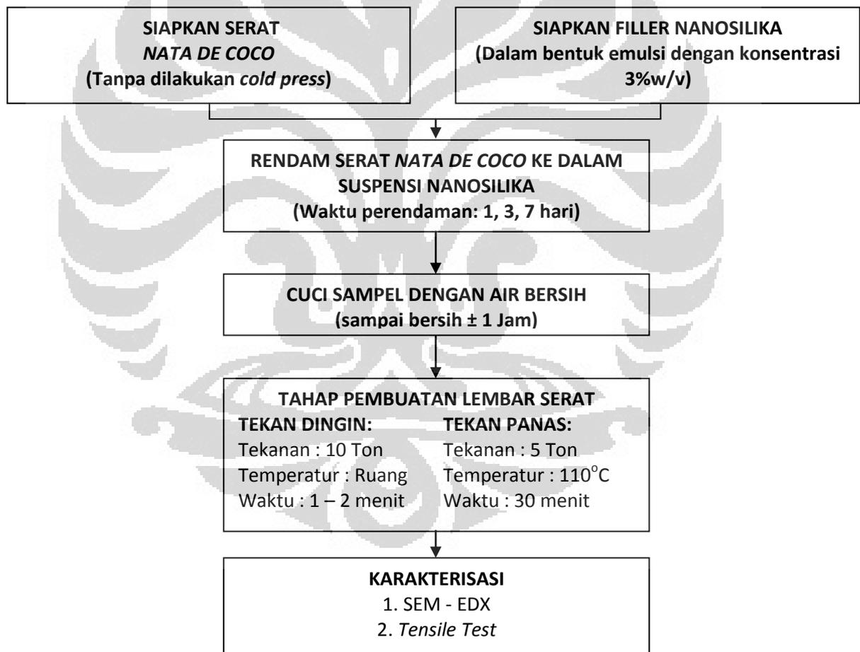
Gambar 3. 3 Diagram Alir Penggabungan Serat/Filler Nanopartikel dengan Teknik *Post-Modification* (Perendaman)
