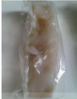
**Gambar 4. 4 Serat *nata de coco* basah dengan lama perendaman 3 hari dalam suspensi nanosilika 3%(w/v)**
