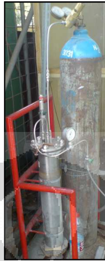
Gambar.3.9 Tabung nitrogen dan pressure vessel yang digunakan dalam pengujian.
