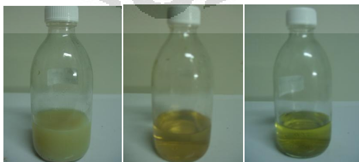
Gambar 4.2 Sampel koloid nanosilver hasil penelitian (reduktor yang digunakan : (a) asam askorbat, (b) asam sitrat, dan (c) trisodium sitrat)
