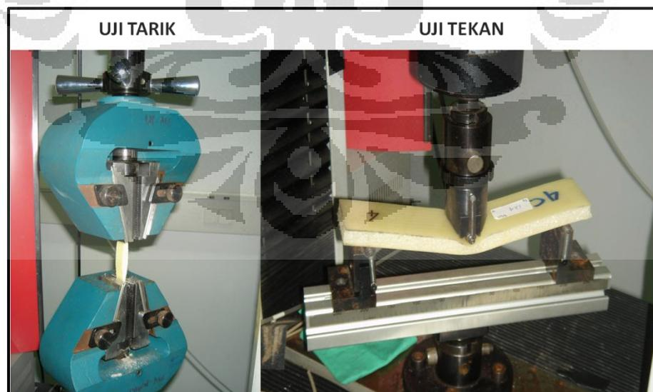
Gambar 3.9. Proses pengujian spesimen.
