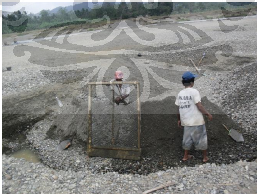
Gambar 5.7 Penambangan pasir di Sungai Lukulo secara manual
