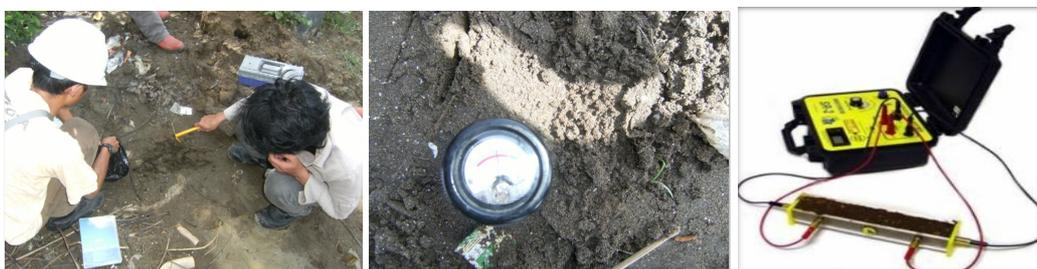
**Gambar 4.8 Pengambilan Sampel Tanah (kiri), Pengukuran pH (tengah), Pengukuran Resistivitas Tanah (kanan)**
