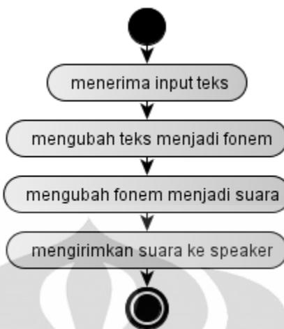
Gambar 3.9. *Activity Diagram* untuk Modul Sintesis Suara
