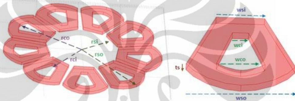
Gambar 3. 2 Pemodelan Geometri Kumparan Stator
