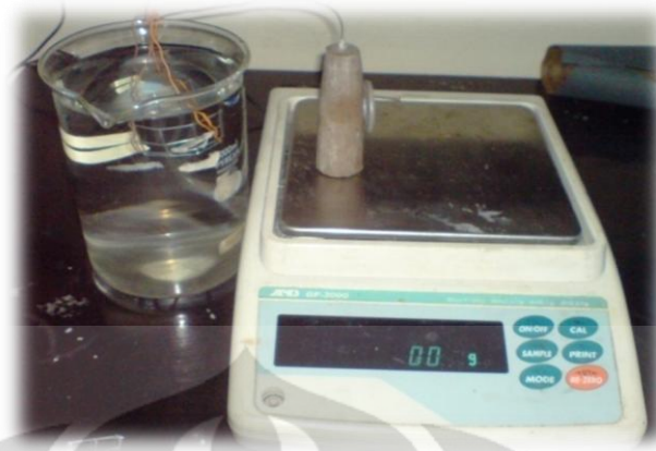
Gambar 3.9 Penimbangan Sampel di Air
