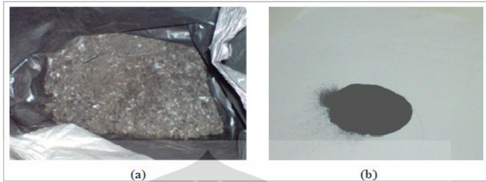
Gambar 4.2 Carbon Black (a) Hasil Pirolisis ; (b) Hasil Pengayakan
