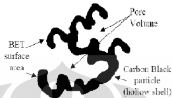
Gambar 2.13 Struktur Carbon Black [30]
