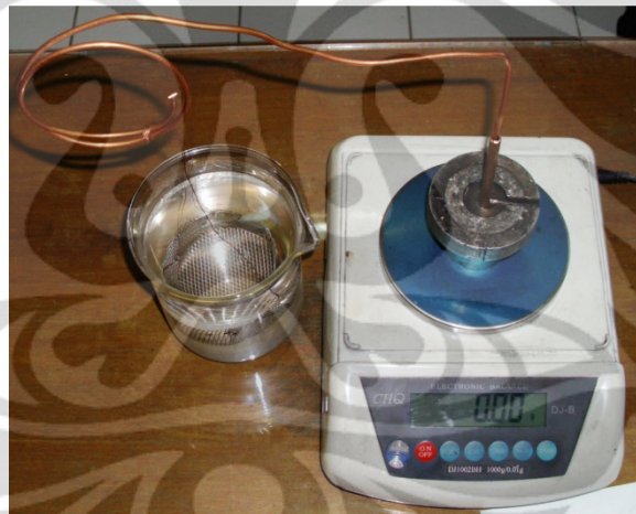
Gambar 3.4 Pengukuran densitas dan porositas
