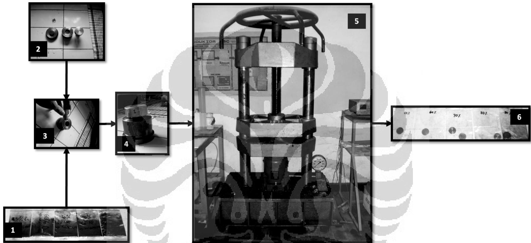
**Gambar 3.10.** Preparasi sampel menggunakan mesin *hot press*: (1) serbuk nanokomposit, (2) cetakan, (3) serbuk nanokomposit dimasukkan ke dalam cetakan, (4) cetakan berisi serbuk nanokomposit, (5) mesin penekan, dan (6) produk silinder dengan diameter dan tebal rata-rata 2 cm dan 2-5 mm.
