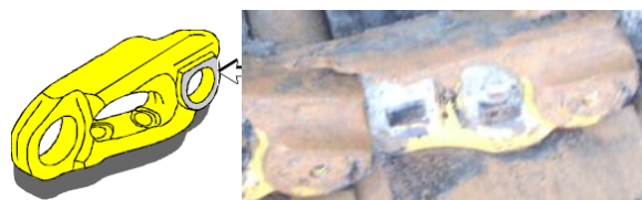
Gambar 39. Kerusakan sisi luar link
