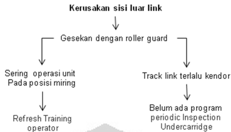
Gambar 38. Kerusakan sudut permukaan link
