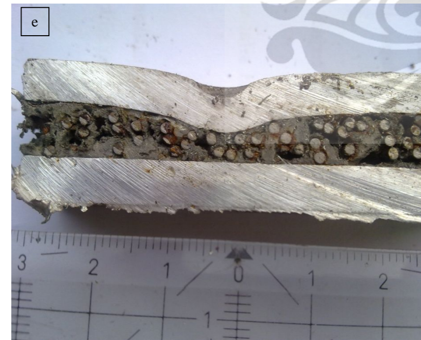
Gambar 4. 14 Penampang melintang pada perforasi komposit aluminium dengan diameter proyektil 9 mm dan 7.62 mm (a-b) fraksi volum 2.5 %. (c-d) fraksi volum 5 % (e-f) fraksi volum 7.5 %
