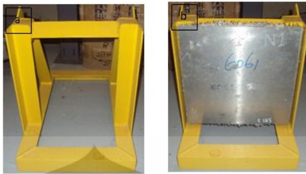
Gambar 3. 23 Backing Plate untuk menahan sampel uji balistik pada pengujian balistik
