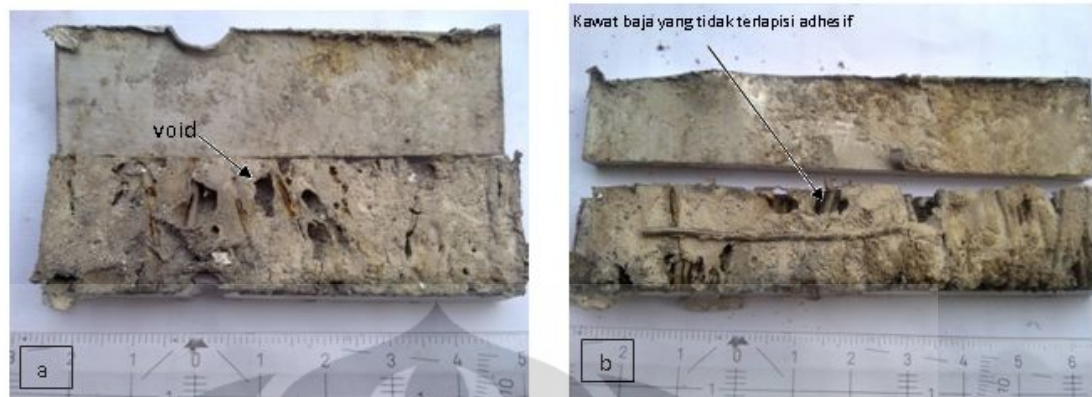
Gambar 4.13 Penampang melintang komposit setelah dibuka (dibelah). (a) fraksi volume 2.5% (b) fraksi volume 5%
