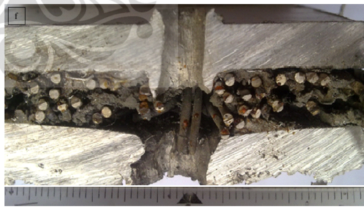
Gambar 4. 14 Penampang melintang pada perforasi komposit aluminium dengan diameter proyektil 9 mm dan 7.62 mm (a-b) fraksi volum 2.5 %. (c-d) fraksi volum 5 % (e-f) fraksi volum 7.5 %
