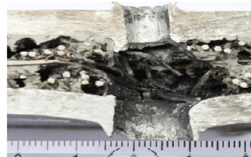
Gambar 4. 19 Perbandingan bentuk penampang melintang hasil uji balistik 7.62 mm antara komposit aluminium penguat kawat baja 1.4 mm dengan komposit aluminium penguat kawat baja 1 mm
