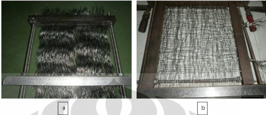
Gambar 4. 16 Perbandingan susunan kawat penguat pada volum fraksi 5 % (a) AA6061 penguat kawat baja 1 mm (b) AA6061 penguat kawat baja 1.4 mm
