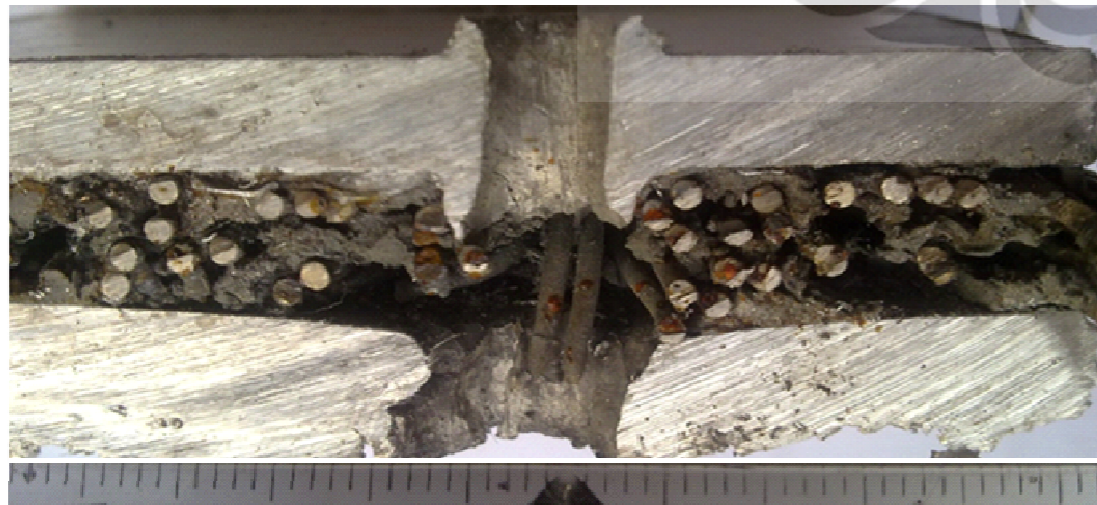
Gambar 4. 19 Perbandingan bentuk penampang melintang hasil uji balistik 7.62 mm antara komposit aluminium penguat kawat baja 1.4 mm dengan komposit aluminium penguat kawat baja 1 mm
