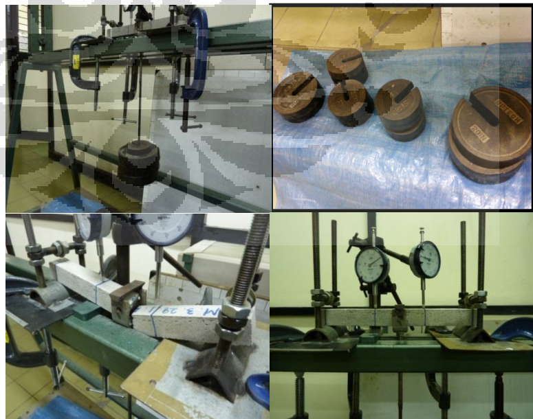
Gambar 3.9 Pengujian Modulus Elastisitas
