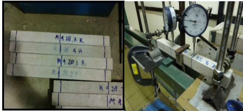
Gambar 3.8 Persiapan benda uji sebelum ditest
