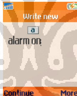
Gambar 4.15 Format SMS untuk mengaktifkan alarm
