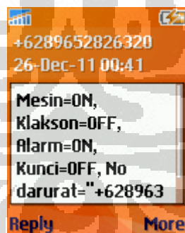
Gambar 4.20 SMS yang diterima setelah mengirimkan perintah 'status'
