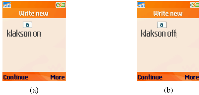
Gambar 4.12 Format SMS untuk mengendalikan klakson. (a) untuk membunyikan klakson dan (b) untuk mematikan klakson
