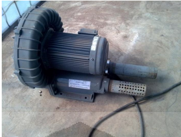
Gambar 3.10 Ring blower pada fluidized bed combustor UI
