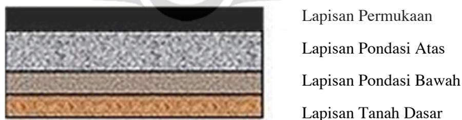
Gambar 2.1. Konstruksi Lapis Perkerasan Jalan
