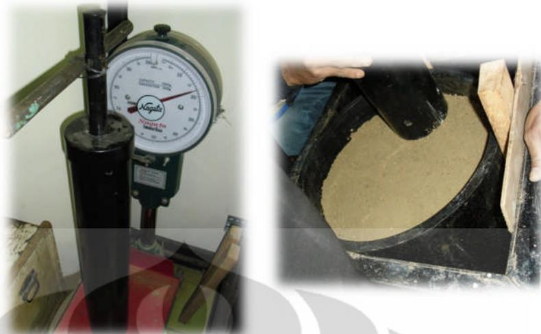
Gambar 3.7 Hammer dan Pematatan Sampel Geogauge
