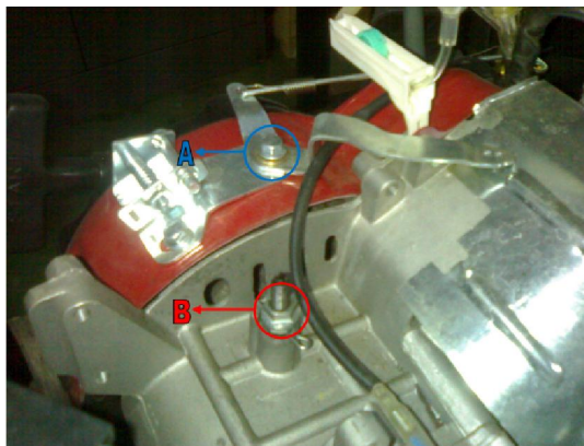
Gambar 3.12, Control Manual Pada Kaburator, (A).Tempat yang baru, paten (B). Governor
