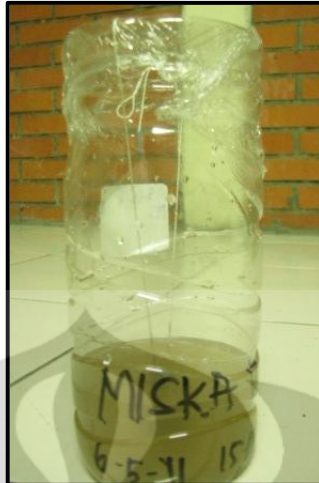
Gambar 3.4. Pengujian Korosi dengan Uji Celup
