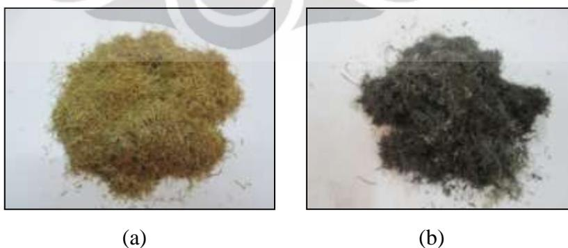
**Gambar 4. 10** Padatan pada proses pirolisis (a) umpan sebelum pirolisis (b) setelah pirolisis
