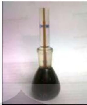
**Gambar 4. 12** Biooil di dalam alat ukur densitas piknometer
