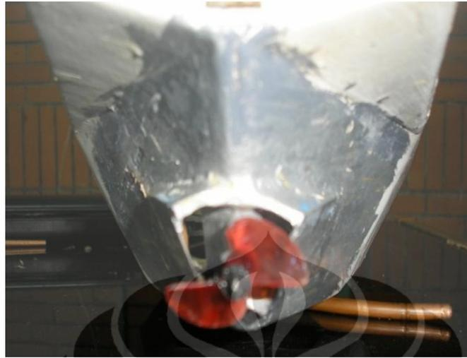
Gambar 3.10 Kapal model dengan *tunnel* pengarah setengah
