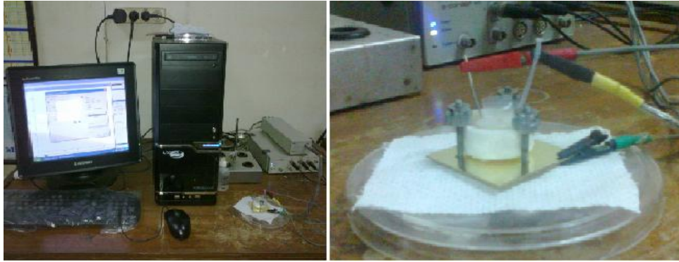
Gambar 4.5 Perancangan sel elektrokimia
