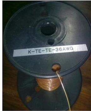
**Gambar 3.11.** *Thermocouple Tipe K*
