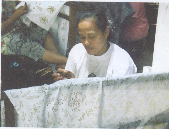
Gambar 3.2.1 Proses nitik batik tulis (Industri Suryanto)
