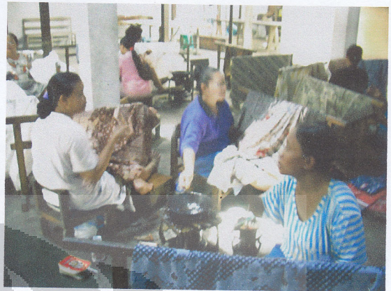
Gambar 3.2.2 Proses nitik batik tulis (Industri Suryanto)
