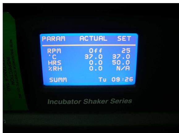
Gambar 3.10 Inkubator yang digunakan untuk uji bioresorpsi secara *in vitro* (kiri) beserta display yang memperlihatkan kontrol suhu pada  $37^\circ\text{C}$  (kanan) di Laptiab-BPPT Serpong.
