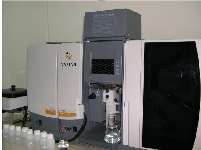
Gambar 3.10 *Atomic Absorption Spectroscopy* (AAS) yang digunakan untuk analisa kandungan unsur kalsium pada larutan SBF di Laptiab-BPPT Serpong.
