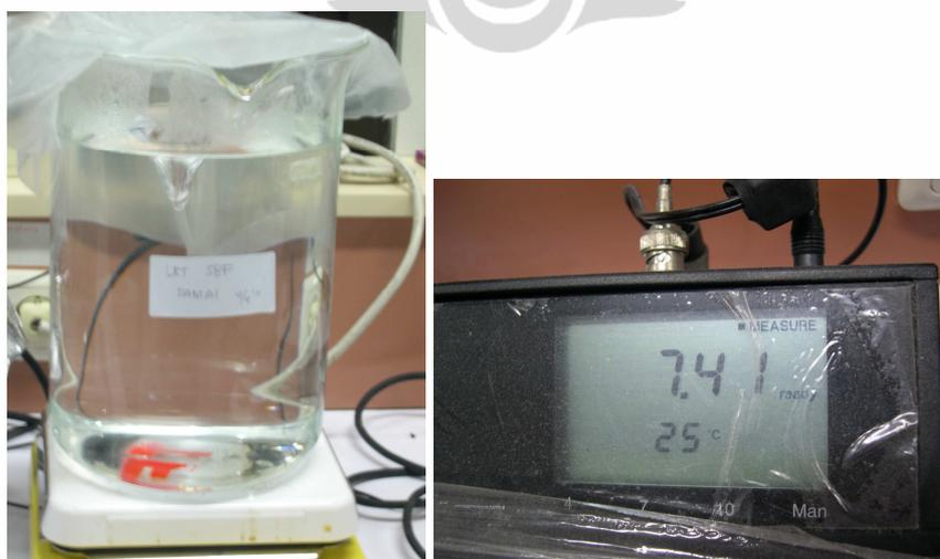
Gambar 3.8 Larutan *Simulated Body Fluid* (SBF) beserta display pH meter yang memperlihatkan nilai pH dari larutan SBF yang dibuat.
