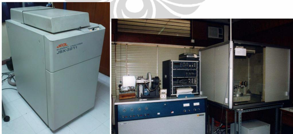
Gambar 3.7 Alat XRF (kiri) dan XRD (kanan) di Lab. Material Science UI Salemba.
