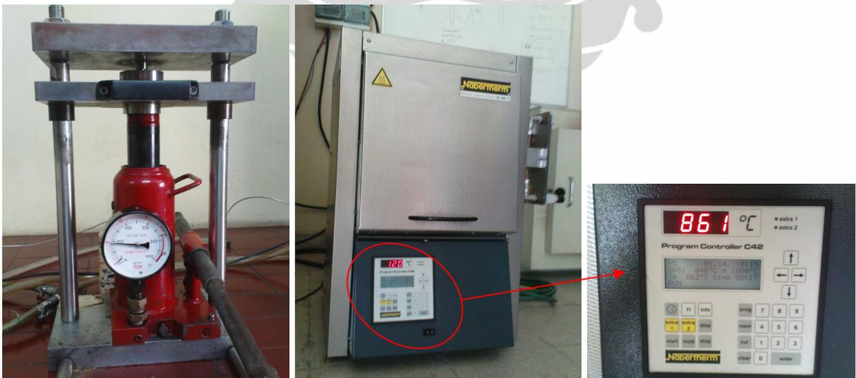
Gambar 3.4 Alat press hidrolis manual yang digunakan dalam pembuatan *disc* BCP di Lab. Material Science UI Salemba (kiri) dan furnis suhu tinggi yang digunakan untuk sintering *disc* BCP di Lab. Teknologi Keramik BPPT (kanan).
