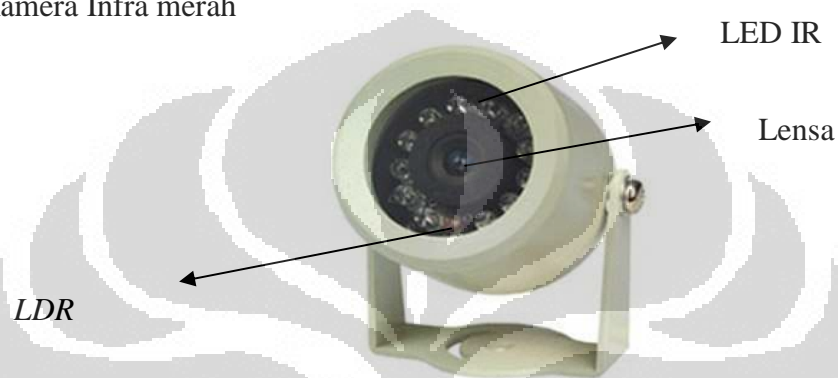
Gambar 3.1. Kamera Infra merah
