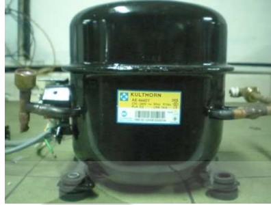
Gambar 3.7 Kompresor Kulthorn Model : AE 4440Y
