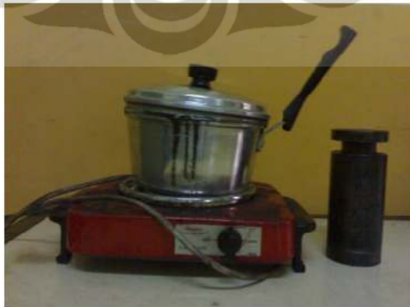
Gambar 3.5 Peralatan dalam pencampuran material komposit BB-ABK- coal tar pitch
