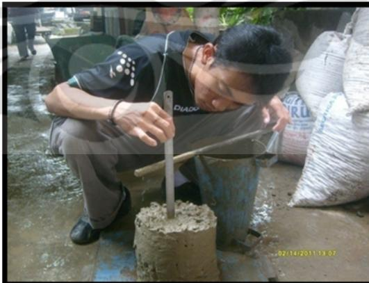
Gambar 3.10 Pengujian Slump
