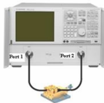
Gambar 4.1 Pengukuran Kinerja LNA dengan pengukuran port ganda.
