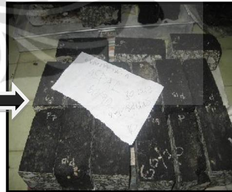
Gambar 3.24 Benda uji setelah dipotong
