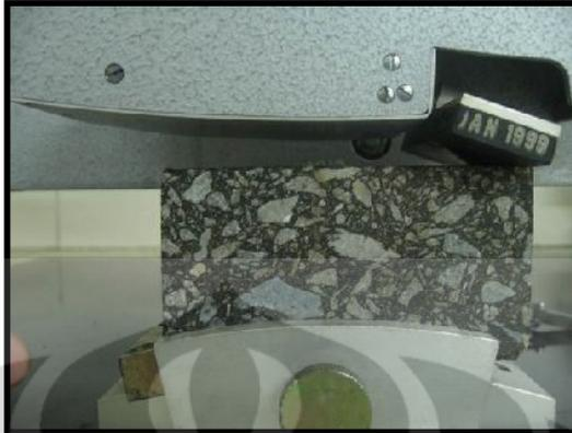
Gambar 3.33 Karet peluncur menyentuh panjang bidang kontak permukaan benda uji (12,5cm)
