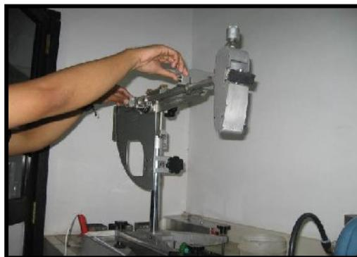
Gambar 3.32 Pengujian dilakukan dengan mengayunkan bandul
