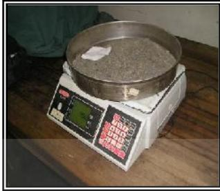
Gambar 3.3 Agregat ditimbang
