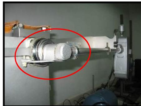
Gambar 3.29 Cek 1 kali ayunan bebas jarum menunjuk tepat di angka 0, dengan mensetting kekencangan tombol pengunci
