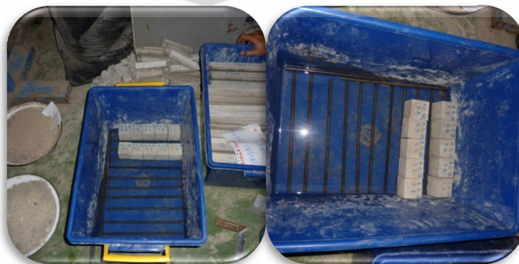
Gambar 3.9 Wadah untuk pengujian absorpsi mortar.
