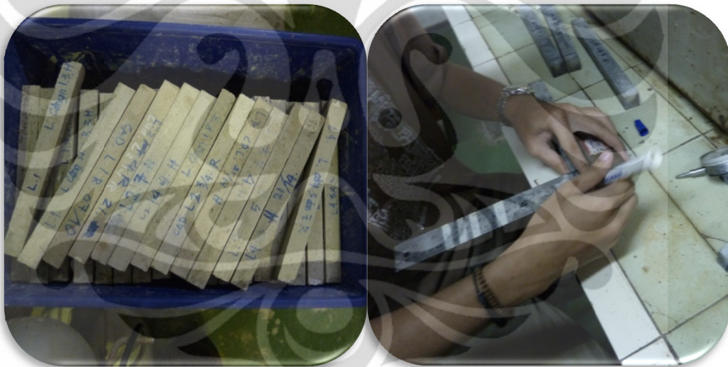
Gambar 3.11 Benda uji modulus elastisitas mortar.
