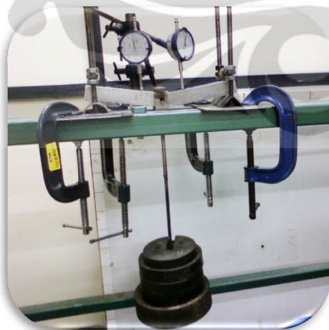
Gambar 2.13 Skema pengujian modulus elastisitas.
