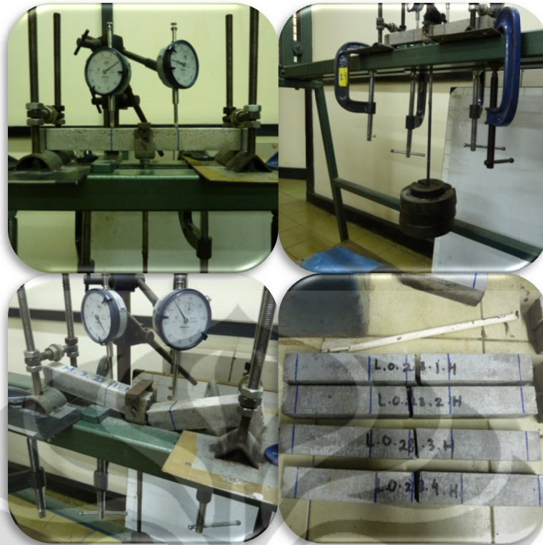
Gambar 3.12 Pengujian modulus elastisitas mortar.
