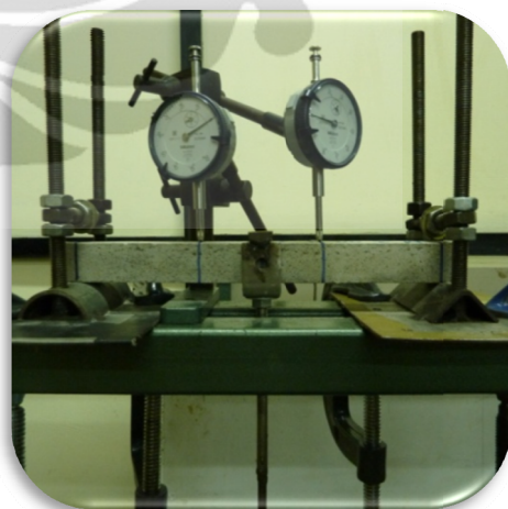
Gambar 2.13 Skema pengujian modulus elastisitas.
