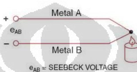
Gambar 2.1 tegangan seebeck yang muncul akibat perubahan temperatur pada termokopel[1]
