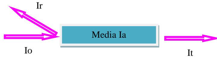
Gambar 2.5 Ilustrasi jalannya sinar pada spektrofotometer
