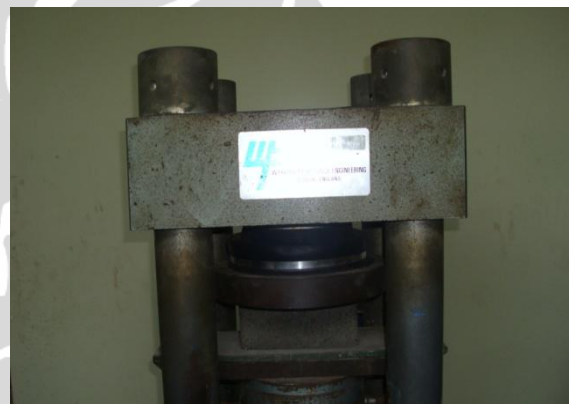
Pengujian Kuat Tekan Paving Block
