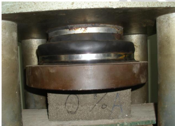
Pengujian Kuat Tekan Paving Block
