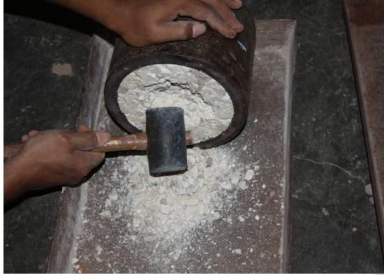
Pengujian Kekerasan Agregat Kasar
