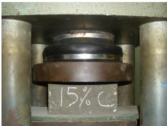
Pengujian Kuat Tekan Paving Block
