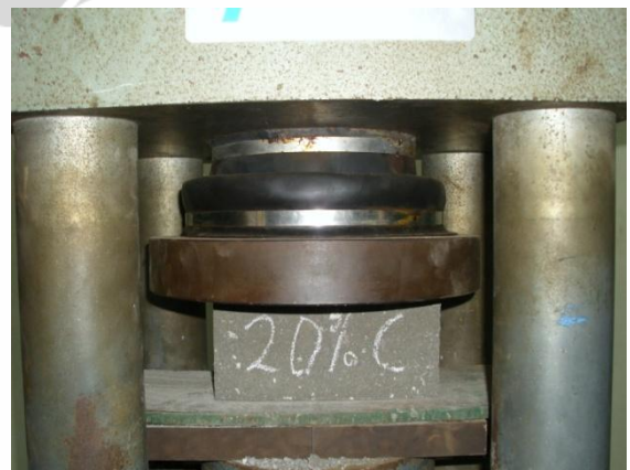
Pengujian Kuat Tekan Paving Block
