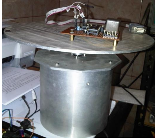
Gambar 3.20. Meja rotasi sebagai platform uji pengendalian sikap satu sumbu
