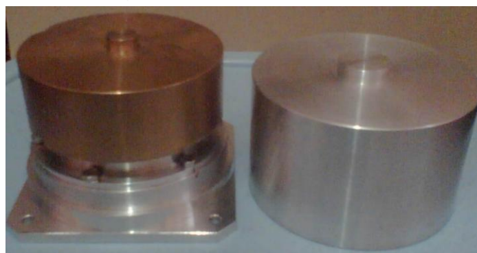
Gambar 3.1. Reaction wheel ditempatkan pada permukaan rata dan stabil
