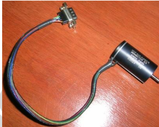
Gambar 2.5. Motor BLDC 2444 048B dari FAULHABER
