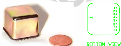
Gambar 2.14. Bentuk fisik sensor MicroGyro100
