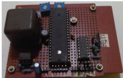
Gambar 5.4. Perangkat sensor giroskop dan sistem akuisisinya
