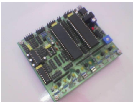
Gambar 3.9. Modul AVR M100 buatan sendiri
