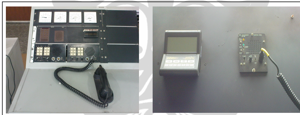
Gambar 2.3. Perangkat remote control unit towerset yang terhubung ke pesawat VHF airband .
