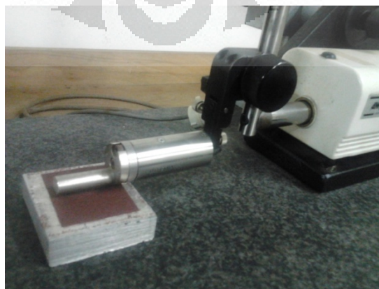
Gambar 3.6 pengukuran ampelas dengan surfcom 120A
