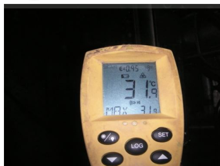
Gambar 3.11 Pengukuran temperatur fluida
