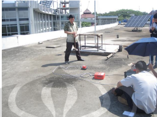
Gambar 4.23. Pemberian Eksitasi Hammer Arah Z Posisi 2
