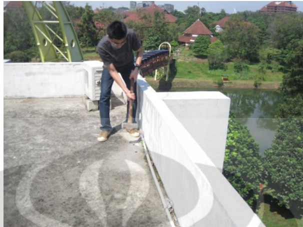
Gambar 4.17. Pemberian Eksitasi Hammer Arah Y Posisi 2
