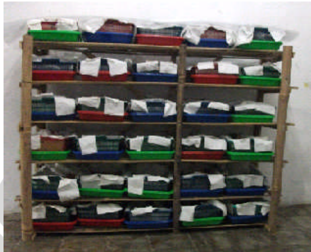
Gambar 3.9 Rak Bambu Tempat Pengeringan Sampel Hasil Flotasi
