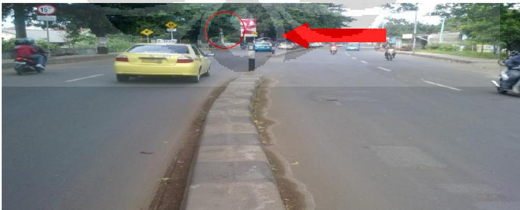
Gambar 4. 11 Kondisi rambu yang tertutup pohon
