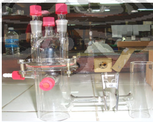
Gambar 3.1. Sel elektrokimia tipe H
