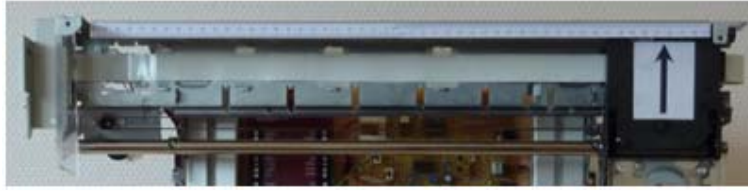
Figure 20. La position du chariot à l'extrémité droite du rail
